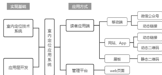
图2 室内定位应用系统实现方式
